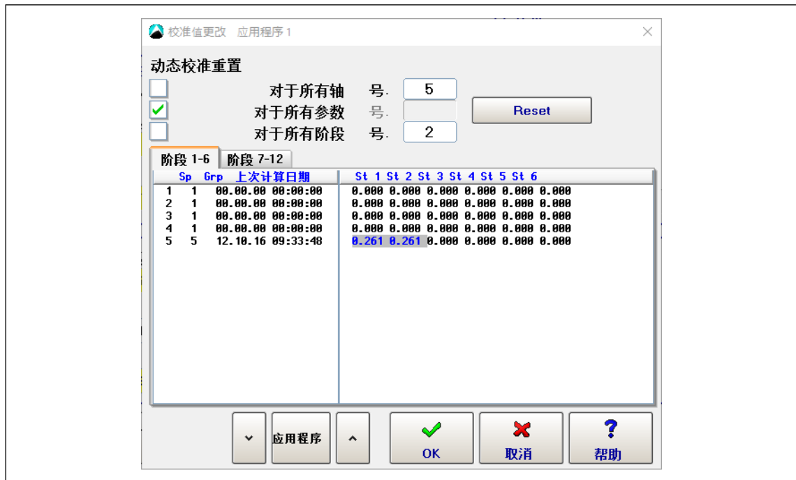
K : 图3-1 : 应用程序1工具5 ( Sp 5 ) 阶段1和2 ( St 1和St 2 ) 已校准的动态电流常数
