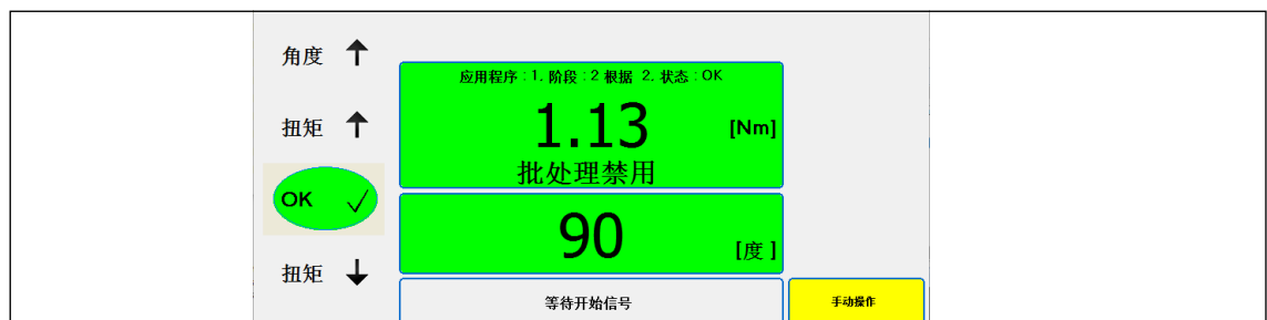
K：图2-2：绿色背景指示工具组1的工具1已在应用程序1中成功运行
