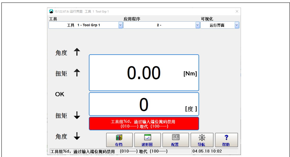
K：图4-3：状态栏以及运行界面的“状态”字段中的消息指示“输入/输出位掩码”中为应用程序2定义的输入（“1”代表输入1，“0”代表输入2，“0”代表输入3，输入4-8未定义）不匹配（“0”代表输入1，“1”代表输入2，“0”代表输入3）。工具被锁定。
