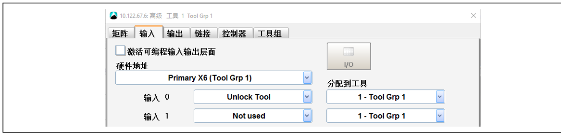
K：图3-3：解锁工具输入信号已映射（输入0）且可编程I/O映射选项已禁用的“高级”对话框的“输入”选项卡
