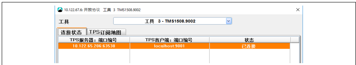
K：图5-1：TPS通过工具3的端口9002连接至全局控制器
