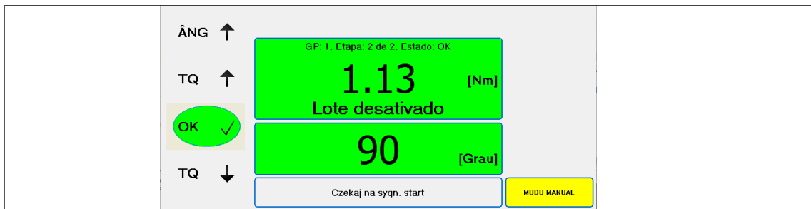
Fig. 4-2: O fundo verde indica que a Ferramenta 1 do Grupo de ferramenta 1 foi executado com êxito no Grupo de Produtos 1
