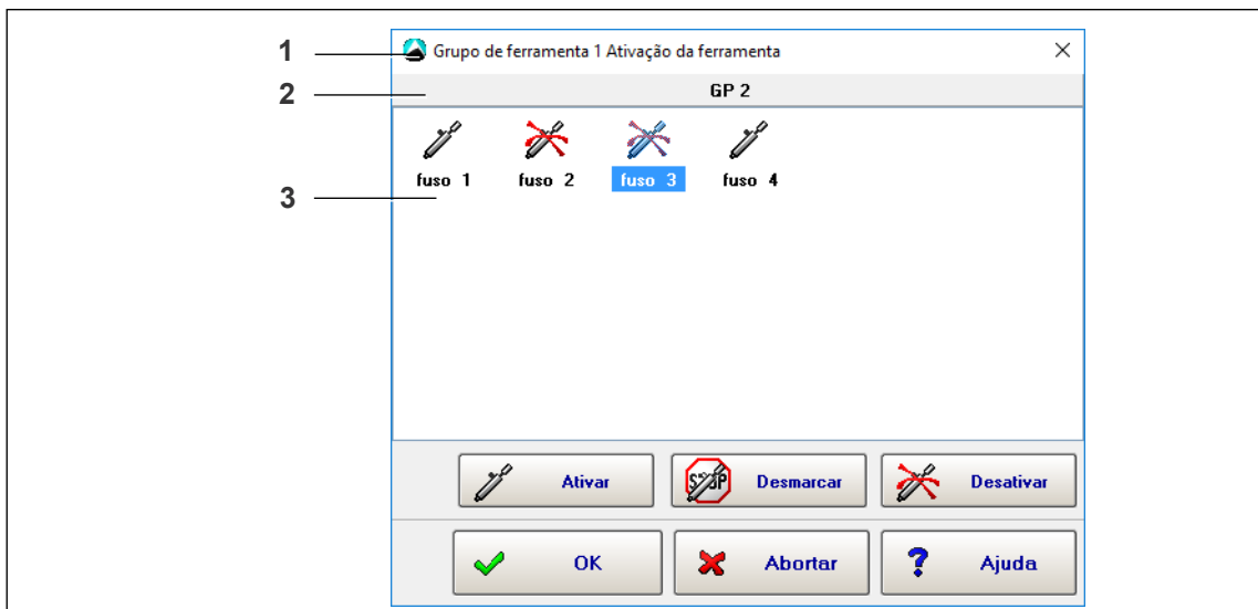
Fig. 5-1: A caixa de diálogo de Ativação da ferramenta com os fusos do Grupo de ferramentas 1 usado para o grupo de produtos 1. Os fusos 1 e 4 são ativados, os 2 e 3 são desativados. A ferramenta 3 está atualmente selecionada.
