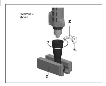
Fig. 10-1: Disassembling gear
